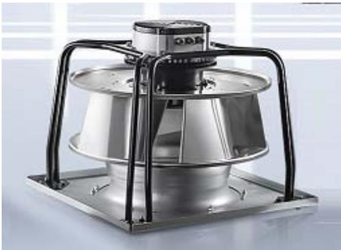
**Ventiladores tipo Plenum Fan**, de trabajo pesado, con Motores Electrónicamente conmutados, (EC), de eficiencia IE4 y superior, de acople directo. Con potenciómetro de ajuste de caudal local, para balanceo y puesta a punto de cada equipo instalado.
